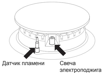
В моделите газови плотове, оборудвани със защита срещу изтичане на газ от горелките, по време на запалването трябва да натиснете докрай копчето на горелката и да го задържите натиснато в продължение на около 10 секунди в позиция „голям пламък”
