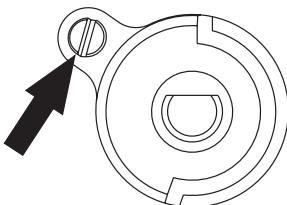
Щоб перевірити полум'я, потрібно прогріти пальник на повному вогні протягом 10 хв., А далі повернути регулювальну ручку вентиля на економне полум'я. Полум'я не повинно згаснути або перескочити на сопло. А якщо так станеться, необхідно повторити регулювання вентилів.
