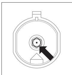
Заміна сопла пальника – сопло викрутити за допомогою спеціального гайкового ключа 7 і замінити на нове згідно з типом газу (див. таблицю вище).
